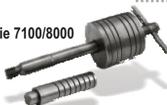
**FE 013****Lixador do assento do elemento (Ø 18mm) na carcaça das bombas série A**
